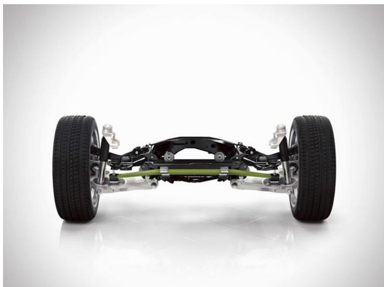
ボルボ XC90、S90、V90 と新型 XC60 のリアアクスルは、軽質なコンポジットを使用した横断型の新リーフスプリングを搭載しています。このコンポジットリーフスプリングはヘンケルのロックタイトマトリックス樹脂を使用してペンテラーエスジーエル社がリアサスペンション向けに量産しています。
