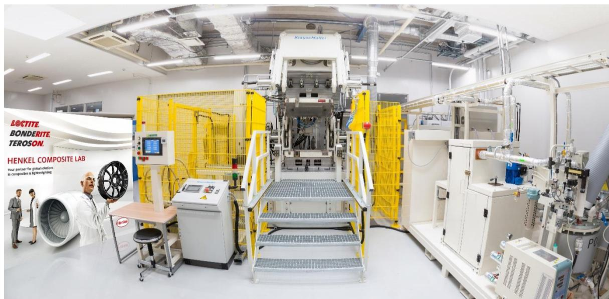
ヘンケルが横浜市磯子区に開設した「コンポジットラボ」。自動車業界の顧客企業と連携し、コンポジット部品の開発や試験、生産プロセスの最適化が進められます。また、型締力 380 トンの成形機を含めた高圧樹脂トランスファー成形システム (HP-RTM) での試作が可能です。
