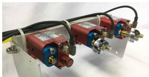
デルタスピードノズルはヘンケル独自技術のダイカスト用油性離型剤「DCLP」の塗布システムに使用する重要なノズルです。「DCLP」は水で希釈する一般的な離型剤とはまったく異なり、希釈不要で金型冷却と離型皮膜形成プロセスを分けて行うシステムで使用します。100%の離型有効成分を超微粒子ミストでスプレーすることで、下記のとおり大変優れた効果が発揮され、高品質のダイカスト品を安定生産できます。
